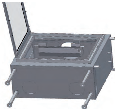
Figuur 2 Plaats de spaarklep en de duwstang.
