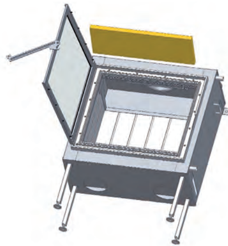
Abb 3 Legen Sie die Rauchgaskehrplatte in den Ofen und bringen Sie die Typen Plakette an
