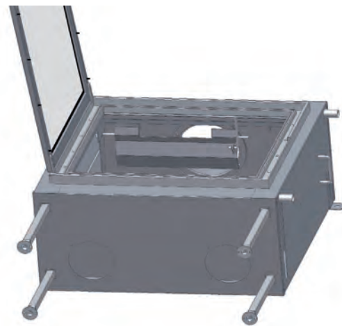
Abb 2 Bringen Sie die Sparklappe ein
