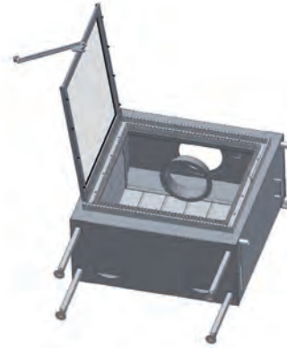
Figure 1 Démontage de la buse des fumées
