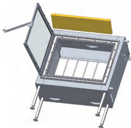
Figuur 2 Plaats de spaarklep en de duwstang.
