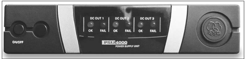
Fig. 1 : Eléments de commande et témoins en façade
