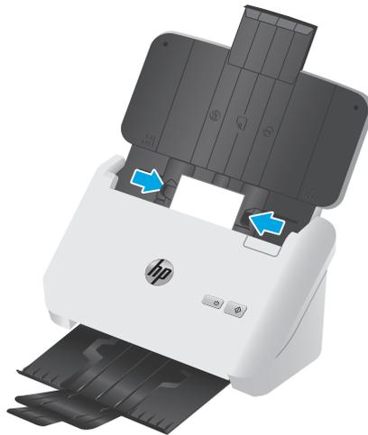
3. **Modèles 3000 s3** : Réglez le petit guide des supports du bac de sortie, et désactivez le paramétrage de détection de multi-alimentation.
