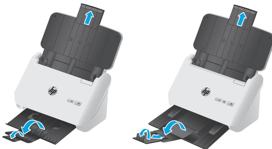
**Modèles 3000 s3** : Pour le bac de sortie, extrayez le bac sous le scanner en le faisant glisser, dépliez la première extension, faites glisser la deuxième extension vers l'extérieur, puis faites pivoter le troisième petit taquet de 90 °.
