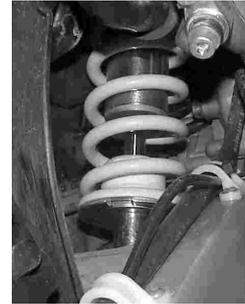
La suspension arrière est un bras oscillant avec amortisseur hydraulique. Il suffit de contrôler l'usure et le jeu du bras oscillant. Si pour une raison quelconque les silentblochs d'ancrage de l'amortisseur se déforment, il faudra alors le remplacer faute de quoi la géométrie du châssis risque de se voir endommagée.
