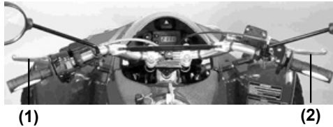
(1). Levier d'embrayage. (2). Poignée de frein avant.
