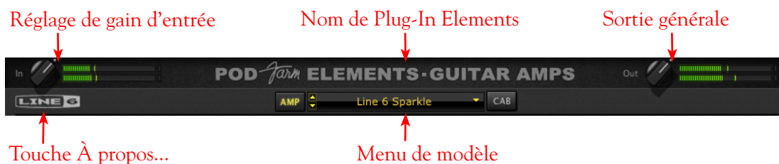
Barre de contrôle générale - Plug-In Elements “POD Farm Distortions”
