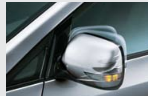
Rétroviseurs électriques rabattables avec clignotants à LED intégré
