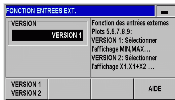
Fig. I.33 Fonction des entrées externes
