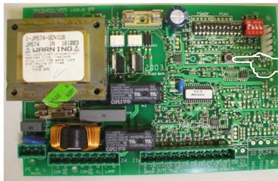
Appuyer sur le poussoir **F** jusqu'à ce que le 1er vantail démarre en ouverture
