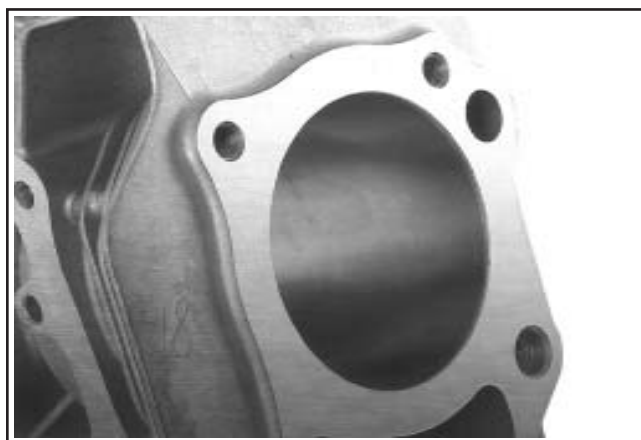
Figure 10-7. Hachure croisée du trou du cylindre après réalésage.
