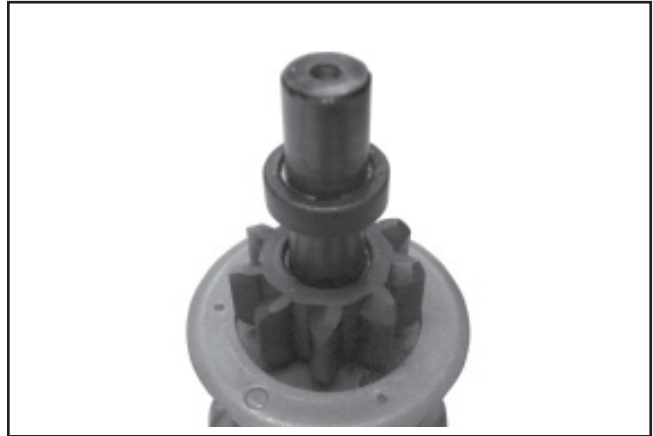
Figure 8-62. Verrouiller le collier autour de la bague de maintien.
