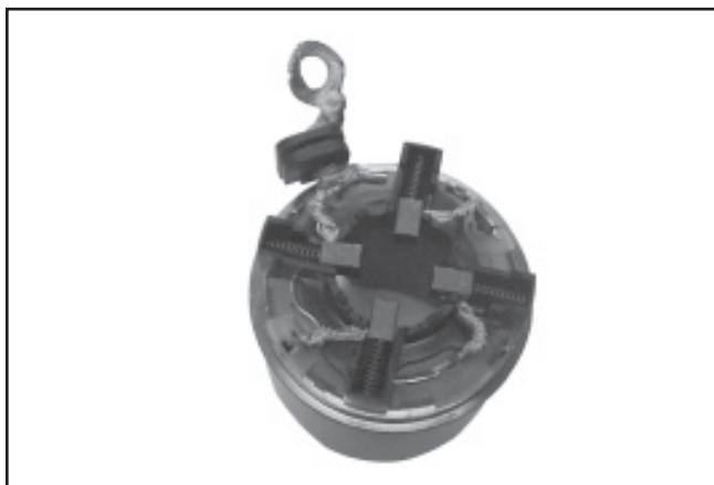
Figure 8-64. Monter le support de balais au châssis.
