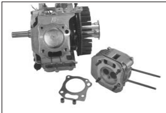
Figure 9-41. Culasse et joint retirés.
