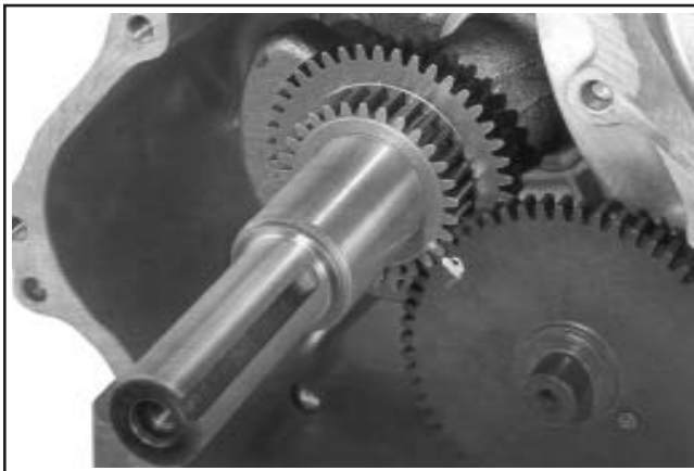
Figure 11-16. CS8.5-12. Alignement des repères de calage du vilebrequin et de l'arbre à cames.
