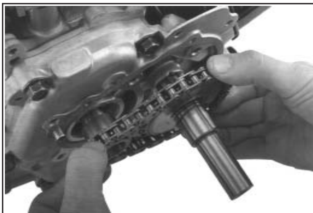
Figure 9-60. Retirer les dents et la chaîne sur CS4, CS6.
