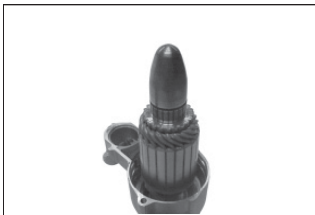
Figure 8-66. Outil sur le bout de l'armature.
