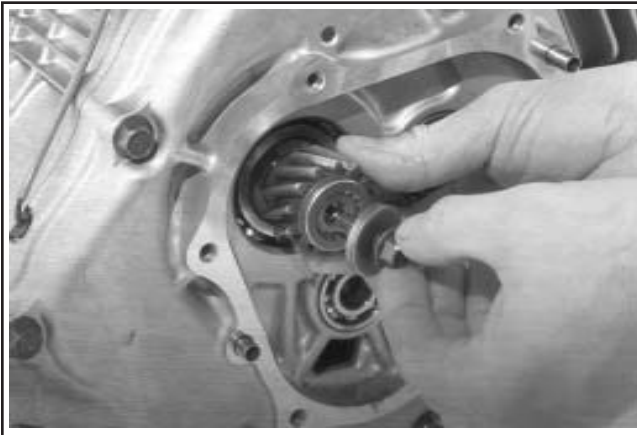
Figure 11-48. Installation de l'engrenage, de la rondelle et de la vis de montage du vilebrequin.
