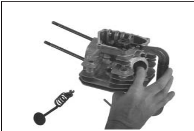
Figure 11-64. Installation des soupapes avec l'outil de compression de ressort de soupapes.
