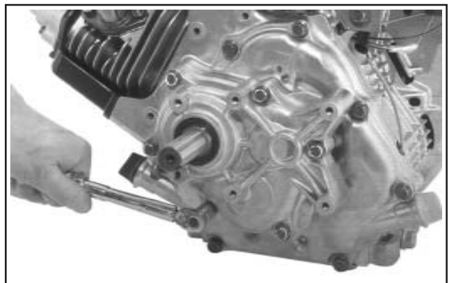
Figure 11-37. CS8.5-12. Serrage des vis de montage du couvercle.
