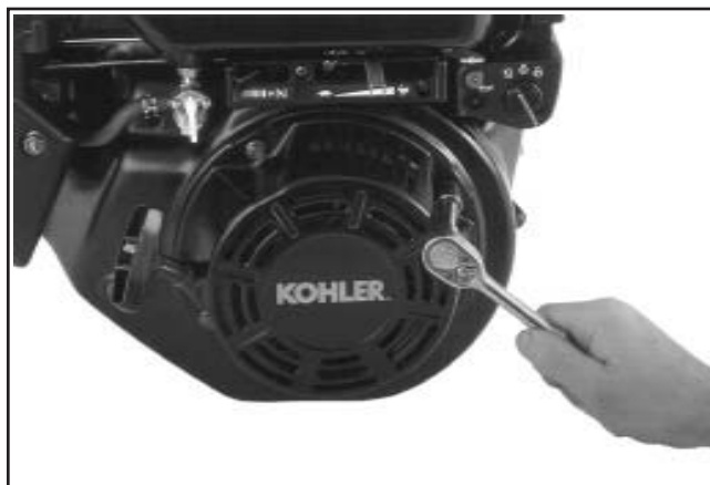
Figure 7-2. Installation du démarreur rétractable.
