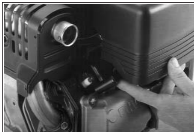
Figure 9-1. Débranchement du câble de bougie.
