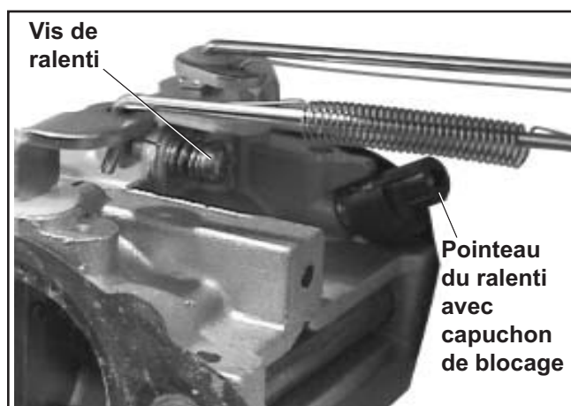
Figure 5-2. Réglages du carburateur.
