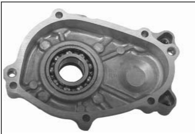
Figure 11-24. CS4, CS6. Installation du palier.
