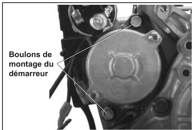
Figure 9-30. Boulons du démarreur sur les modèles avec démarreur à solénoïde.
