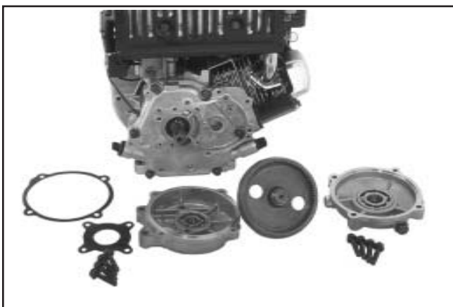
Figure 9-69. CS4, CS6 6:1 Composants de l'ensemble de réduction.
