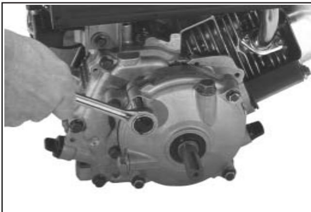
Figure 9-64. Desserrer les vis du couvercle du carter de réduction.
