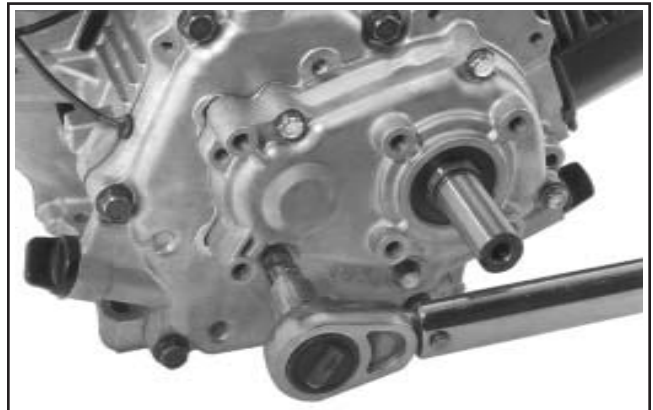
Figure 11-36. CS4, CS6. Serrage des vis de montage du couvercle.
