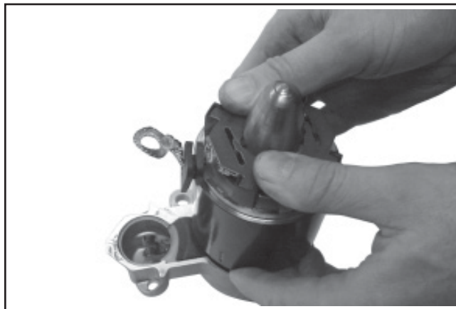
Figure 8-67. Installer le châssis avec l'ensemble de la plaque à balais.
