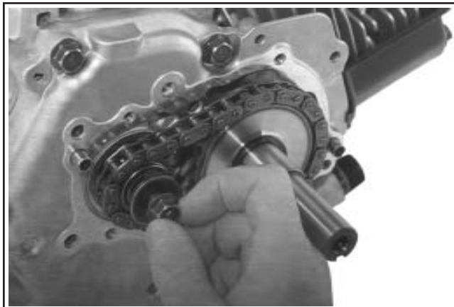
Figure 11-30. Installation de la rondelle et du boulon de montage.
