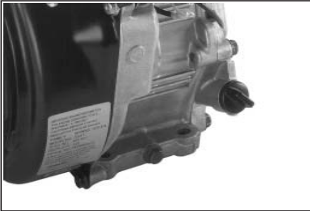
Figure 6-4. CS4, CS6 Emplacement droit du bouchon de remplissage d'huile/contrôle.
