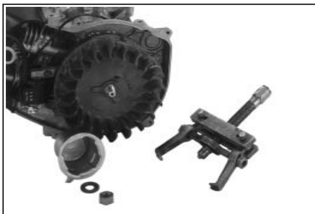
Figure 9-50. Utiliser l'extracteur externe pour retirer le volant sur les CS4, CS6.
