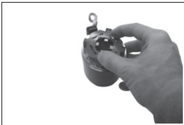
Figure 8-65. Tenir l'isolateur en place.
