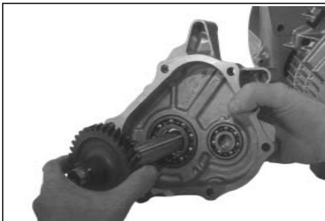
Figure 9-72. Retrait l'engrenage/arbre de sortie du couvercle.
