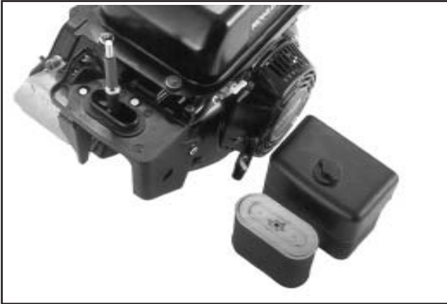
Figure 9-6. CS8.5 (spéc. 92xxxx), base du filtre à air CS10 et CS12.
