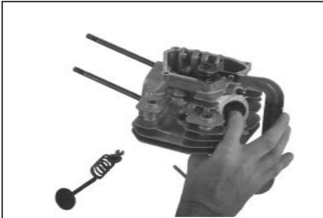
Figure 9-43. Démontez les ensembles de soupapes.
