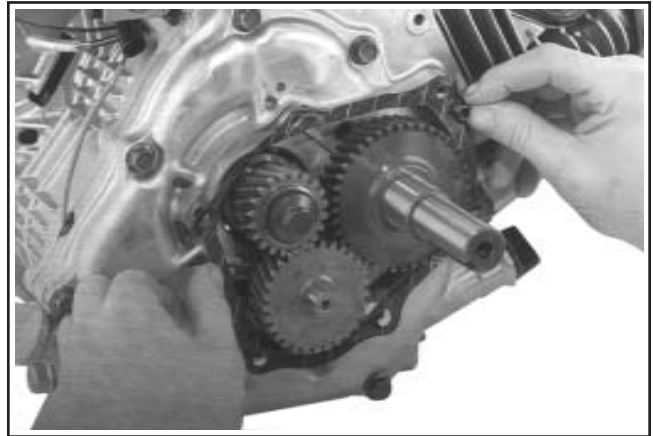
Figure 11-35. CS8.5-12. Installation des broches de guidage et du joint.
