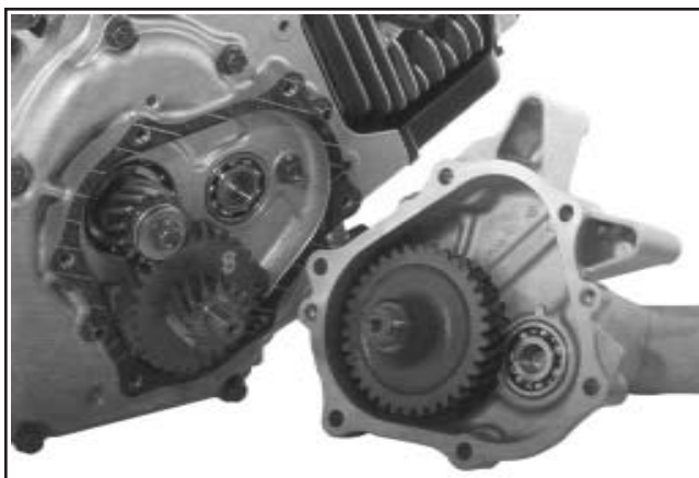
Figure 9-71. Retrait du couvercle du carter.
