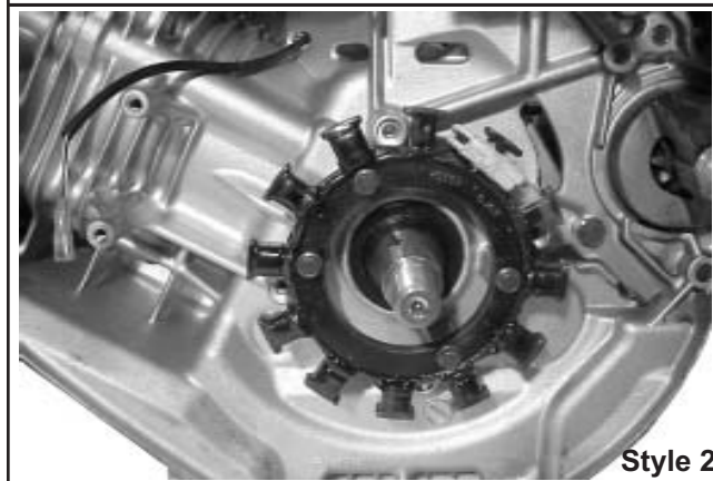
Figure 9-52. Stator et écran de protection.
