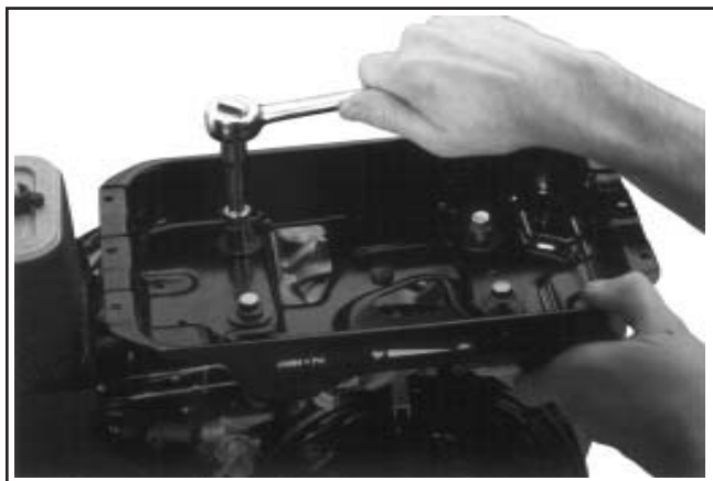
Figure 11-112. CS8.5 (spéc. 95xxxx) installation du support du réservoir de carburant.
