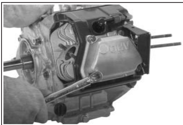
Figure 11-79. CS8.5-12. Serreage des vis du couvercle de soupape.
