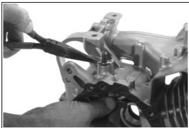
Figure 9-87. Retirer la goupille d'attelage de l'arbre intermédiaire du régulateur.
