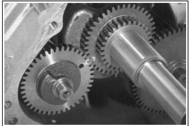
Figure 11-17. CS8.5-12. Alignement des repères de calage de l'arbre d'équilibrage et de l'engrenage.
