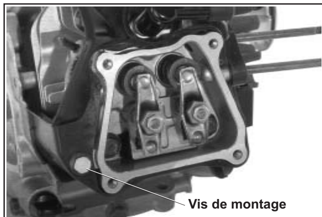
Figure 9-39. CS4, CS6 Emplacement de la vis de montage.
