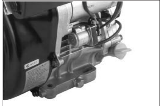
Figure 6-6. CS8.5-12 Emplacement droit du bouchon de remplissage d'huile/contrôle.
