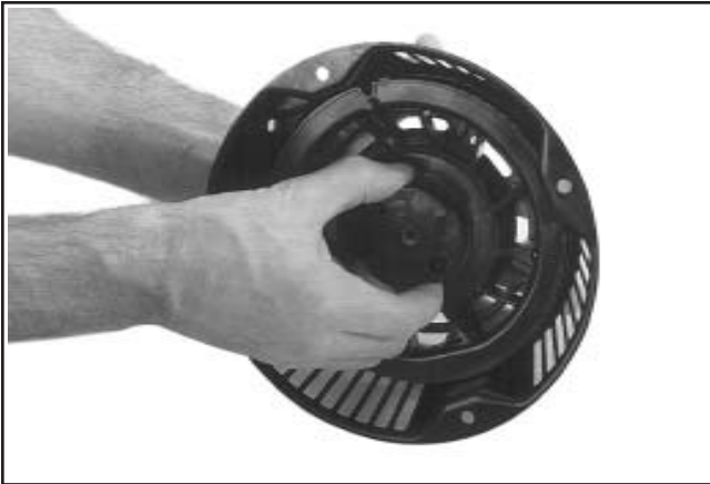
Figure 7-10. Monter la poulie du démarreur sur le carter.
