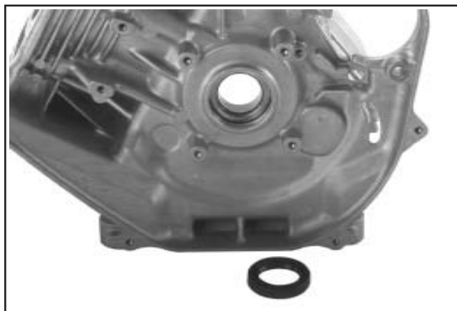
Figure 9-89. Joint d'huile retiré.
