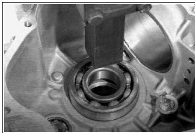
Figure 11-1. Installation d'un palier à l'aide d'une presse.
