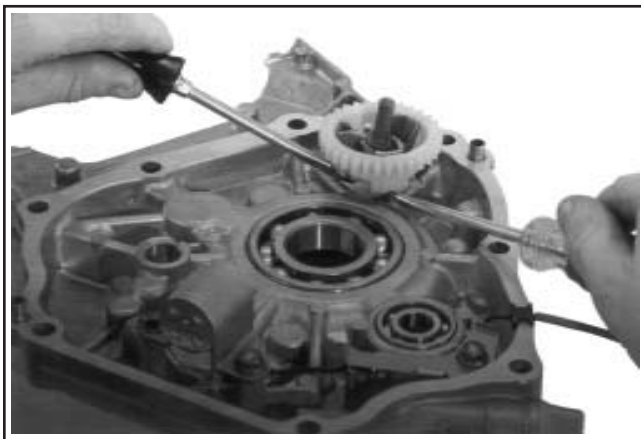
Figure 10-19. Retrait de l'engrenage du régulateur.
