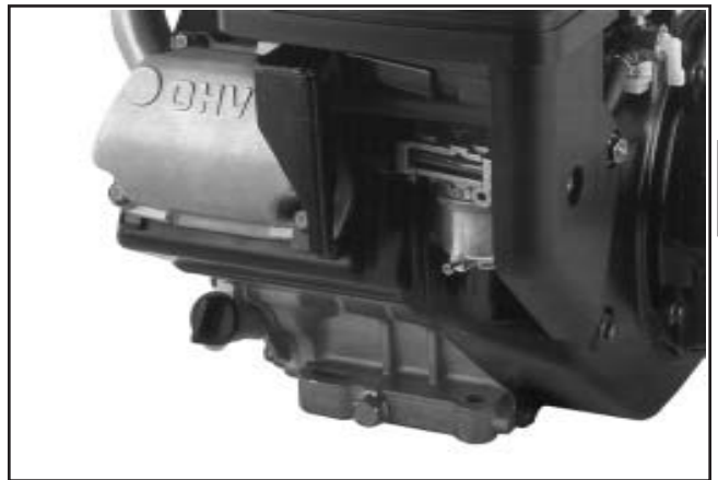
Figure 6-7. CS8.5-12 Emplacement gauche du bouchon de remplissage d'huile/contrôle.
