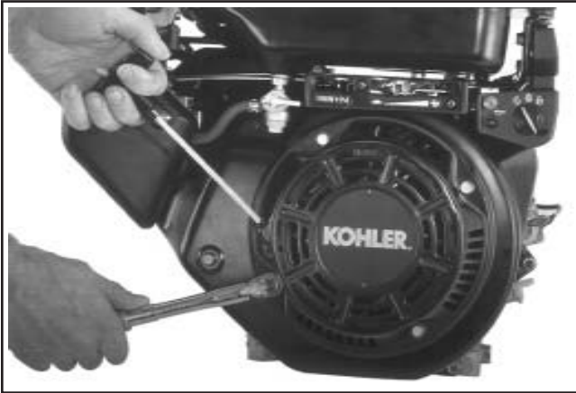
Figure 11-116. Enclenchement des cliquets et serrage des vis de fixation.
