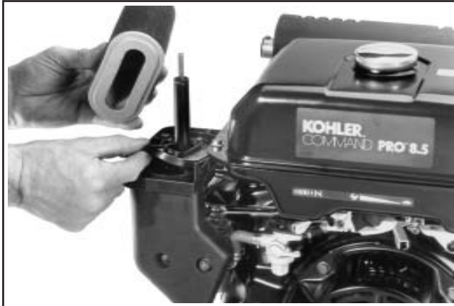
Figure 4-14. Plaque de base en caoutchouc à réviser.
