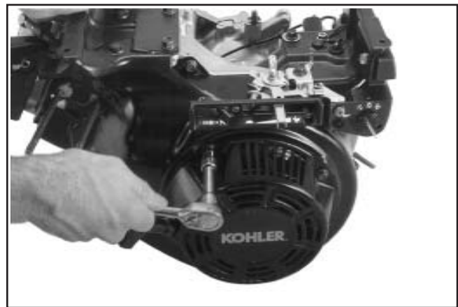
Figure 9-18. Retrait des vis de montage du démarreur.
