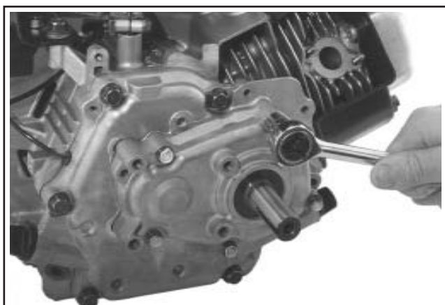
Figure 9-54. Retirer les vis du carter de réduction sur CS4, CS6.
