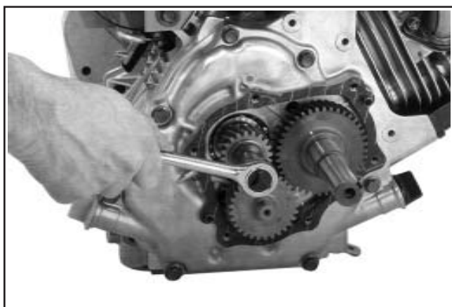
Figure 9-59. Retirer la vis du vilebrequin sur CS8.5-CS12.
