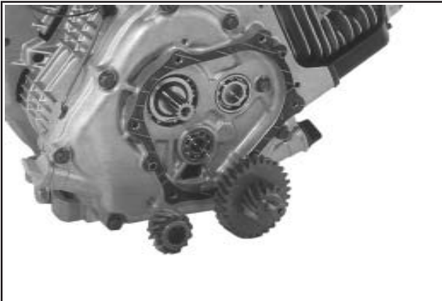
Figure 9-73. Retirer l'engrenage de renvoi et l'engrenage à cames.
