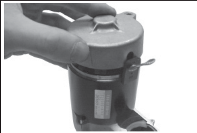
Figure 8-68. Installation du capuchon d'extrémité.
