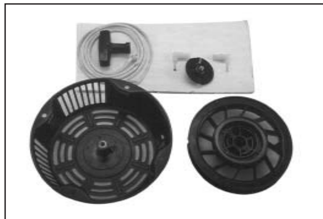
Figure 7-9. Démarreur rétractable démonté.
