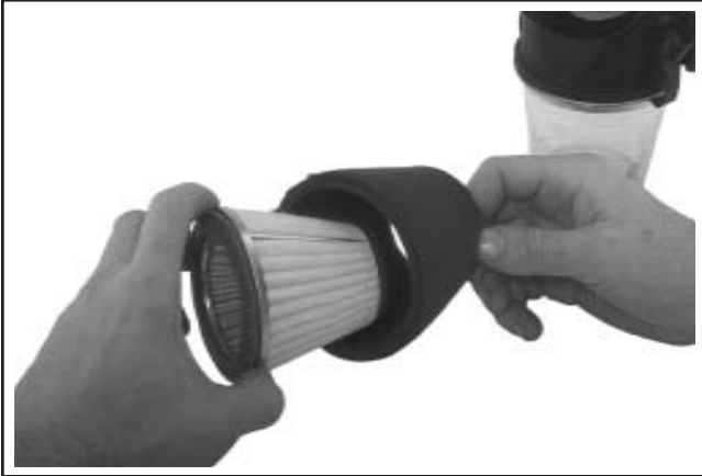
Figure 4-8. Dépose du préfiltre industriel.
