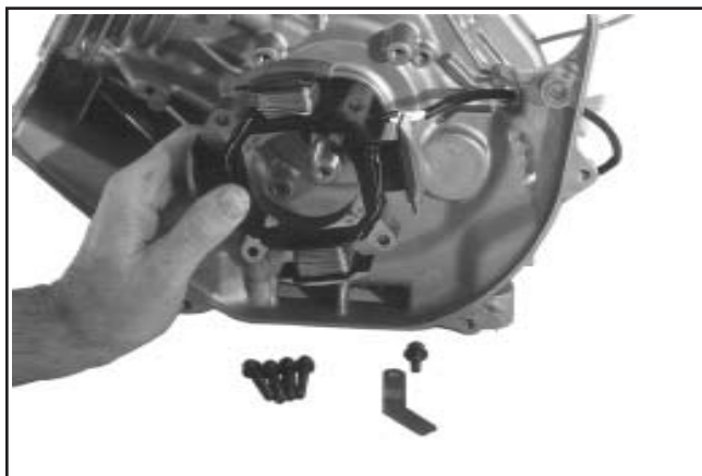
Figure 9-53. Retrait des vis de montage et du stator.
