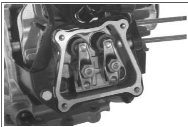
Figure 11-77. CS4, CS6. Emplacement du boulon de montage de la grille de prise d'air de la culasse.
