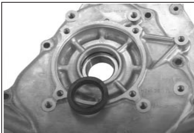
Figure 9-80. Joint du vilebrequin retiré.
