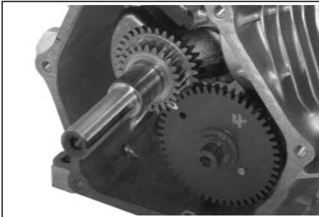
Figure 11-15. CS4, CS6. Aligner les repères de calage du vilebrequin et de l'arbre à cames.
