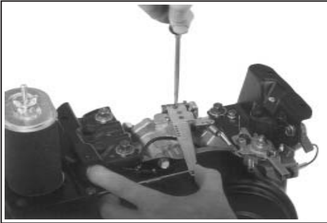
Figure 11-108. CS4, CS6. Régler le régulateur.
