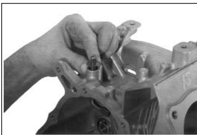
Figure 11-5. Installation de la rondelle extérieure.
