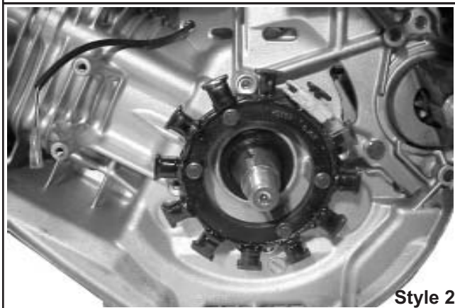
Figure 11-54. Installation des vis de montage du stator.
