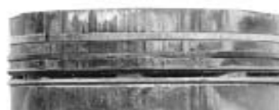
Piston et segments éraflés
