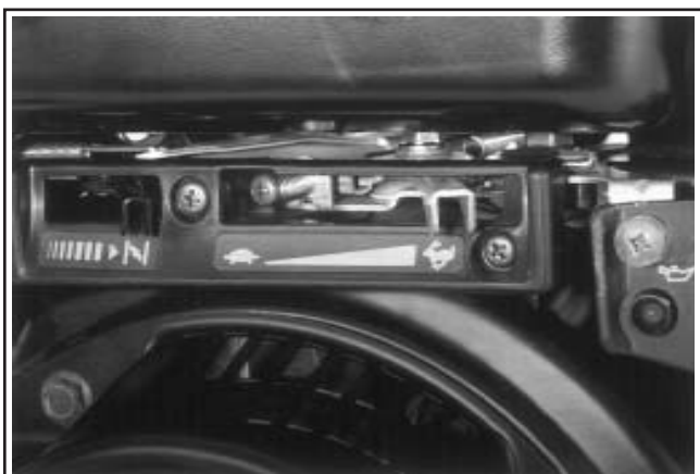
Figure 11-119. CS8.5 (spéc. 92xxxx), CS10, CS12 : Vis de limite de régime maximum.
