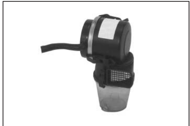
Figure 4-2. Filtre à air cyclonique industriel.
