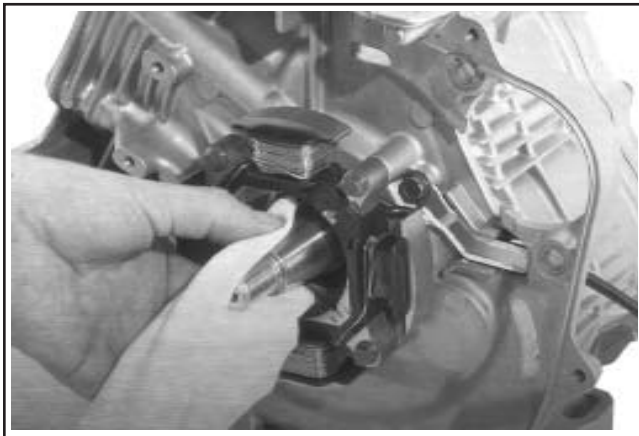
Figure 11-57. Nettoyage et séchage du tenon du vilebrequin.
