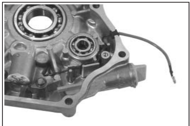
Figure 11-18. Détails du montage de la jauge d'Oil Sentry™ et de l'acheminement de câble.
