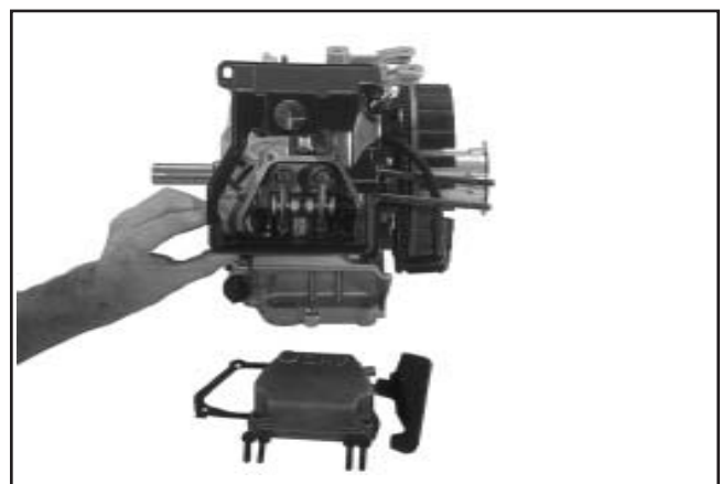
Figure 9-38. Couvercle de la soupape, joint et grille de prise d'air retirés.
