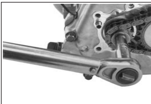
Figure 11-31. Serrage des boulons de montage.
