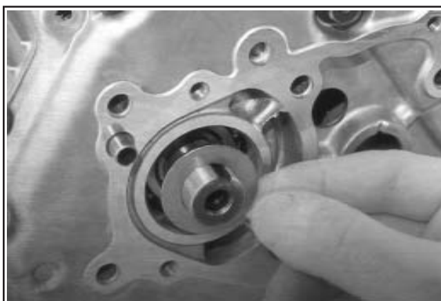
Figure 9-61. Rondelle de butée derrière les dents de démarrage sur CS4, CS6.
