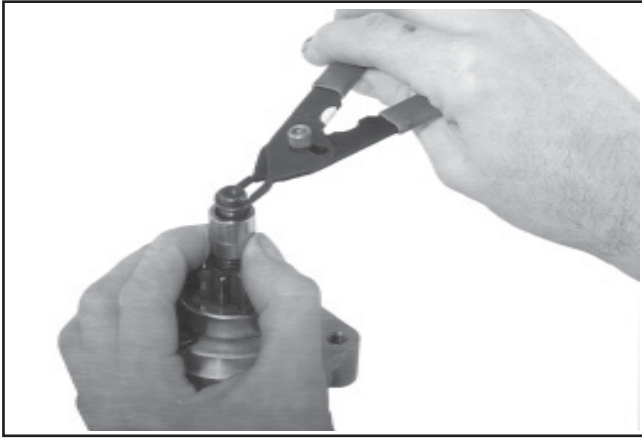
Figure 8-35. Retirer la bague de maintien.
