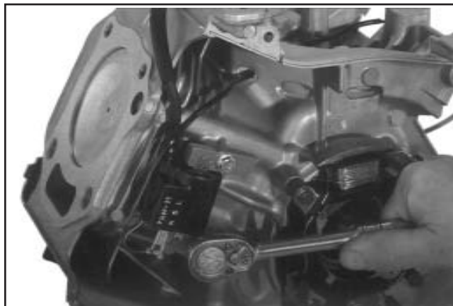
Figure 9-51. Retrait des vis du module d'allumage.
