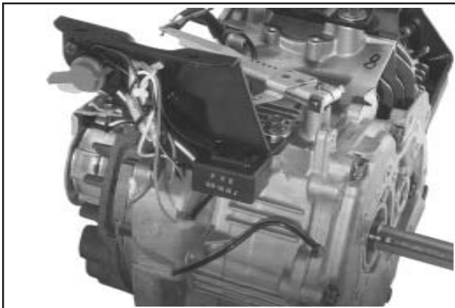
Figure 11-93. CS8.5 (spéc. 92xxxx), CS10, CS12 : Reconnecter les câbles électriques.
