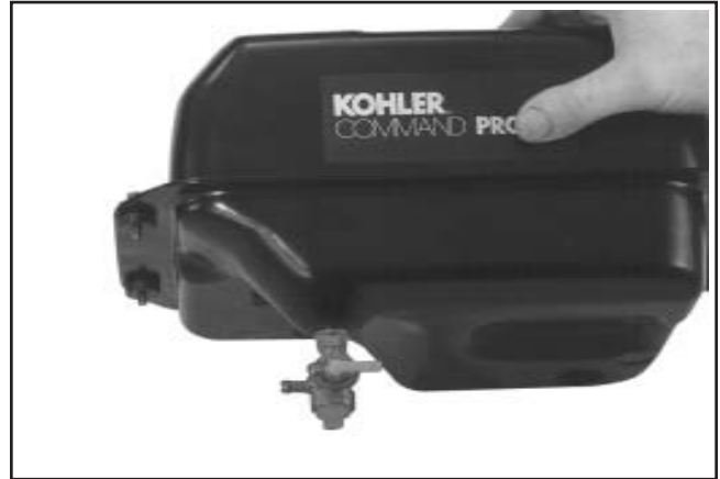
Figure 11-110. CS4, CS6, CS8.5 (spéc. 92xxxx), CS10, CS12 : Orientation de la soupape d'arrêt.
