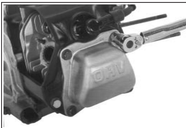
Figure 11-78. CS4, CS6, CS8.5 (spéc. 95xxxx). Serrer les vis du couvercle de soupape.
