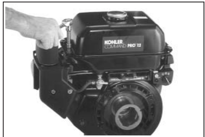
Figure 11-111. Serrage des vis de montage du réservoir de carburant.
