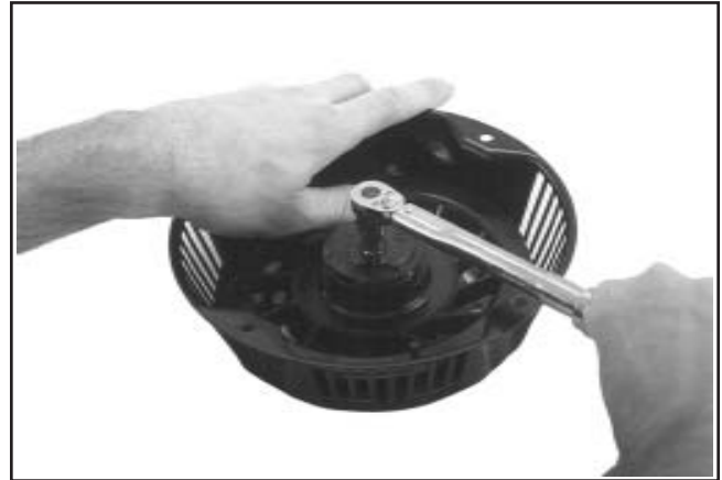
Figure 7-11. Serrer la vis de fixation centrale.
