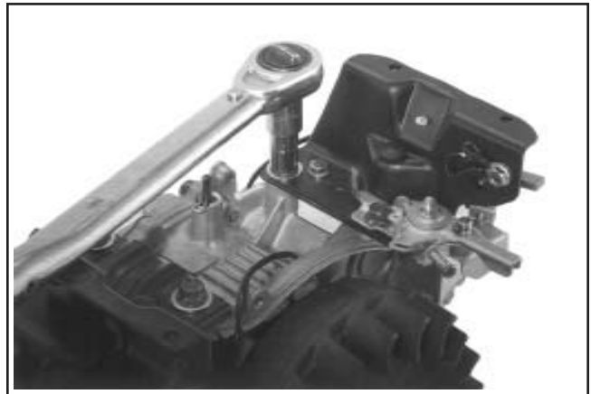
Figure 11-83. CS4, CS6. Montage du support du réservoir de carburant droit.
