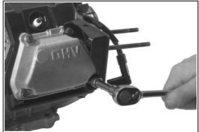
Figure 9-36. Retirer les vis du couvercle de soupape avec le support de fixation attaché.
