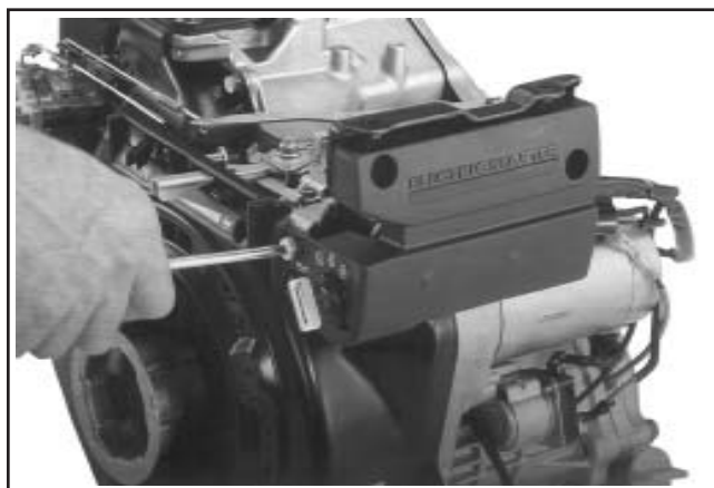
Figure 11-99. CS8.5 (spéc. 92xxxx), CS10, CS12 : Attacher le panneau du couvercle du démarreur électrique.
