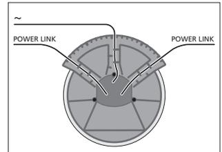
*Pour des raisons de sécurité, passez les câbles d'enceinte dans les guides câbles.*
