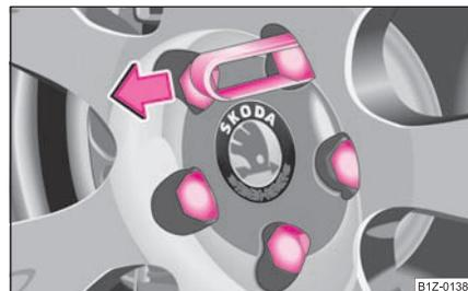
Fig. 167 Dépose du chapeau de roue
