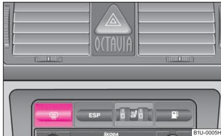
Fig. 53 Contacteur du chauffage de lunette AR
