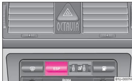
Fig. 139 Contacteur ESP
