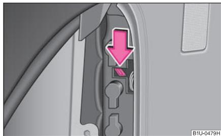
Fig. 186 Coffre à bagages: Support d'ampoule
