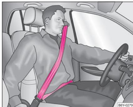
Fig. 116 Position correcte de la sangle baudrier et de la sangle sous-abdominale ▶
