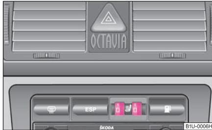
Fig. 68 Tableau de bord: Régulateur rotatif du chauffage des sièges avant
