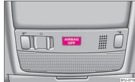
Fig. 129 Témoin de contrôle pour la désactivation de l'airbag du passager avant
