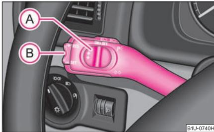
Fig. 109 Manette de commande: Interrupteur et contacteur du régulateur de vitesse
