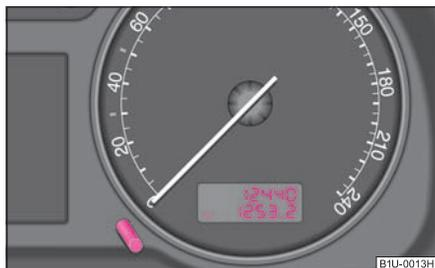
Fig. 19 Combiné d'instruments: Compteur pour le trajet parcouru
