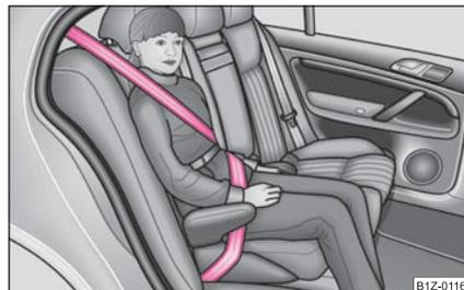
**Fig. 136** Siège pour enfant monté sur le siège arrière dans le sens de déplacement selon groupe 3
