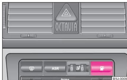
Fig. 145 Contacteur pour ouvrir la trappe du réservoir depuis la place du conducteur
