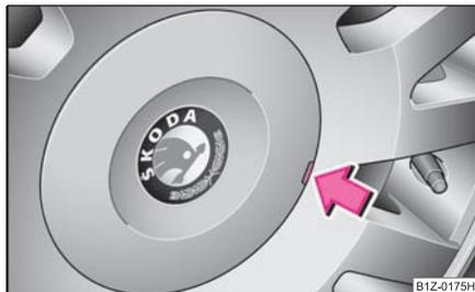
Fig. 168 Déposer l'enjoliveur d'une roue en alliage léger
