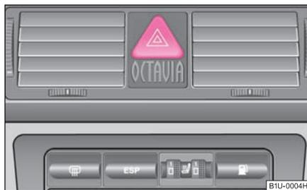
**Fig. 49** Tableau de bord: Contacteur pour feux de détresse
