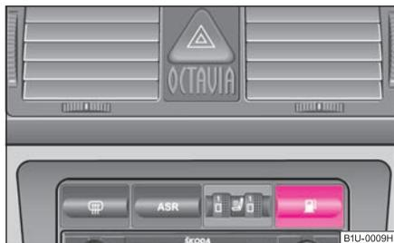
Fig. 12 Contacteur pour ouvrir la trappe du réservoir depuis la place du conducteur
