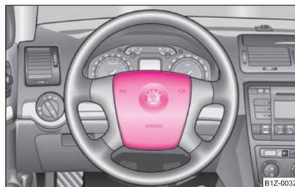
**Fig. 122 Airbag du conducteur dans le volant** ▶
