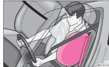
Fig. 127 Airbags latéraux remplis de gaz
