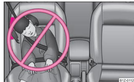
**Fig. 131** Un enfant pas correctement protégé, ni assis dans la bonne position – est en danger à cause de l'airbag latéral
