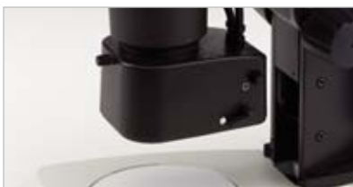
Éclairage coaxial pour les surfaces planes et très réfléchissantes des tranches et des échantillons polis de métaux
