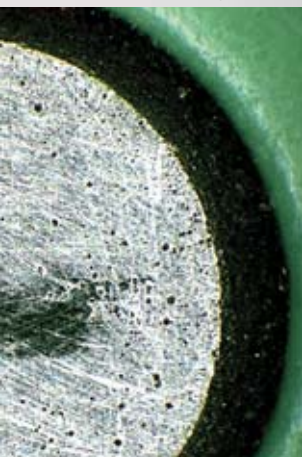
Piqûre de corrosion dans le éclairage coaxial
