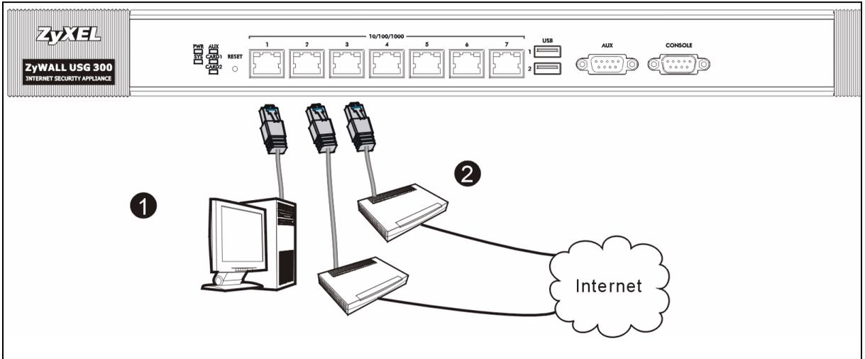
1 Es wird empfohlen, die ZyWALL zu konfigurieren, bevor Sie sie zum in Ihrem Netzwerk einsetzen. Schließen Sie einen Computer mit einem Ethernetkabel an Port 1 an.
