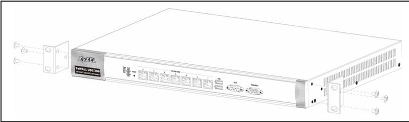
2 接上两个托架后，将托架的螺丝孔对齐机架对应的螺丝孔，以此方式将开关安装在机架内。利用机架安装螺钉将开关固定于机架上。
