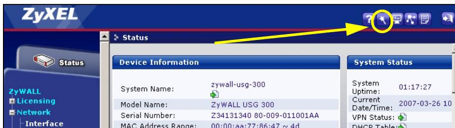
インストールセットアップウィザードより ZyWALL の登録および、IDP やコンテンツフィルタなどのトライアルを有効にできます。
