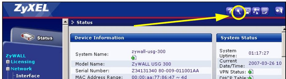
Мастер первоначальной настройки installation setup wizard служит для подключения к Интернету и регистрации устройства ZyWALL и/или активации пробного доступа к дополнительным сервисам, таким как служба обнаружения и предотвращения вторжений или фильтр контента.
