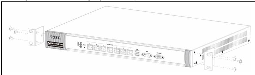
2 Установите устройство в стойку в выбранную позицию и, убедившись в правильности его положения, закрепите предназначенными для монтажа в стойку винтами.
