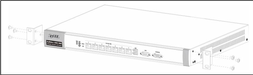
**2** Wenn Sie beide Montagehalterungen befestigt haben, richten Sie die ZyWALL im Rack aus, dass die entsprechenden Schraublöcher übereinander stehen. Befestigen Sie den ZyWALL mit den Befestigungsschrauben am Rack.
