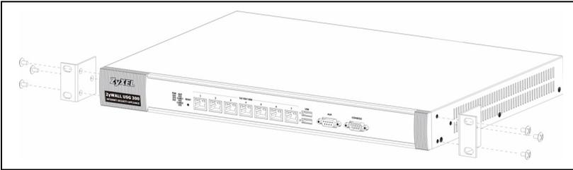
2 取り付け用金具の穴とラックの穴を合わせ、ZyWALL をラックに配置します。付属のネジで ZyWALL をラックに固定します。
