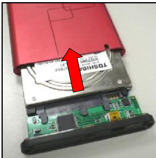
Figure 5. Réinsérer le adaptateur drive plus et connecte les vis
