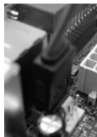
将 SATA 数据线连接到 eSATAII 接口 (SATAII_TOP)
