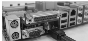
Conecte el otro extremo del cable de dispositivo eSATAII al puerto eSATAII del escudo de E/S
