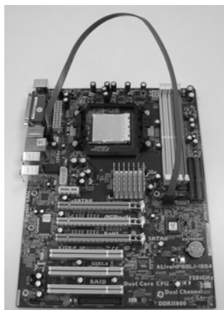
将 SATA 数据线连接到 eSATAII 接口 (SATAII_TOP)
