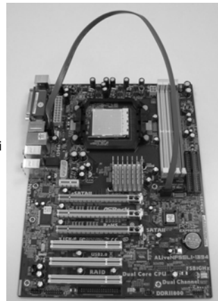
Collegare il cavo dati SATA al connettore eSATAII rosso (eSATAII_TOP)
