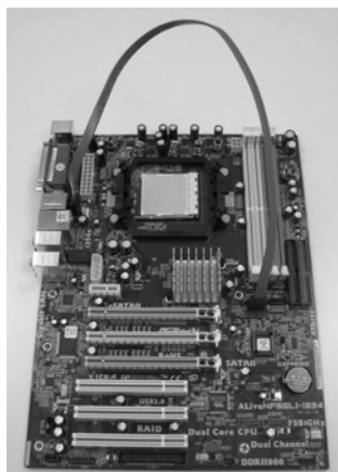
Connectez le câble de données SATA au connecteur SATAII (eSATAII_TOP)
