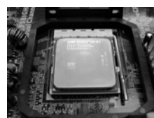
FASE 4: Abbassare e bloccare la levetta socket
