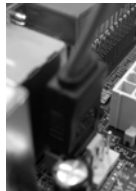
Conecte el cable de datos SATA al conector rojo eSATAII (eSATAII_TOP)
