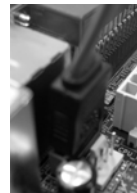
Collegare il cavo dati SATA al connettore eSATAII rosso (eSATAII_TOP)
