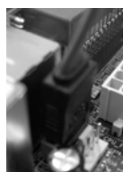
Connectez le câble de données SATA au connecteur SATAII (eSATAII_TOP)
