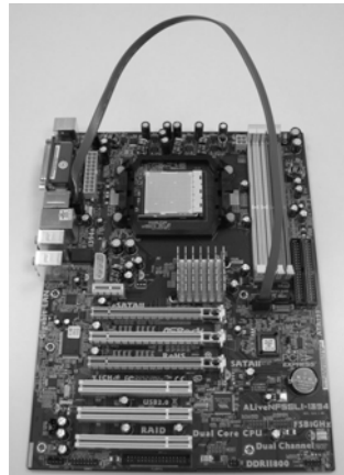
Conecte el cable de datos SATA al conector rojo eSATAII (eSATAII_TOP)
