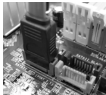
Collegare il cavo di dati SATA al connettore red SATAII (SATAII_RED (PORT 2.1))
