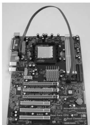
SATAデータケーブルを赤いeSATAIIコネクタ(eSATAII_TOP)に接続します
