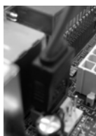
SATAデータケーブルを赤いeSATAIIコネクタ(eSATAII_TOP)に接続します
