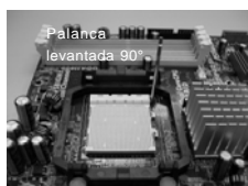
PASO 1: Levante la Palanca del Zócalo
