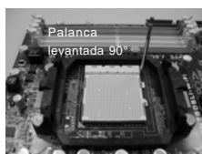
PASO 1: Levante la Palanca del Zócalo
