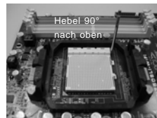
SCHRITT 1: Ziehen Sie den Sockelhebel hoch
