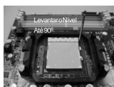
PASSO 1: Levantar o Nível de Tomada Até 90°
