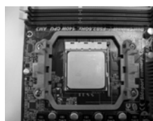
步骤 4： 下推并锁住插座拉杆
