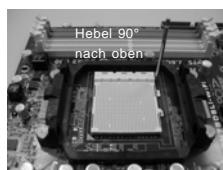
SCHRITT 1: Ziehen Sie den Sockelhebel hoch
