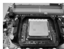
FASE 4: Abbassare e bloccare la levetta socket
