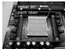
SCHRITT 1: Ziehen Sie den Sockelhebel hoch
