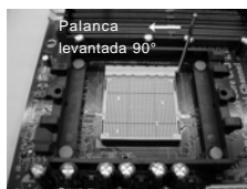
PASO 1: Levante la Palanca del Zócalo
