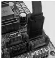
SATAデータケーブルをオレンジのSATAIIコネクタに接続します。(SATAII_ORANGE (Port3))
