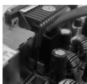
将 SATA 数据线连接到 eSATAII 接口(eSATAII)
