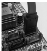
将 SATA 数据线连接到橘色的 SATAII 接口(SATAII_ORANGE (Port3))
