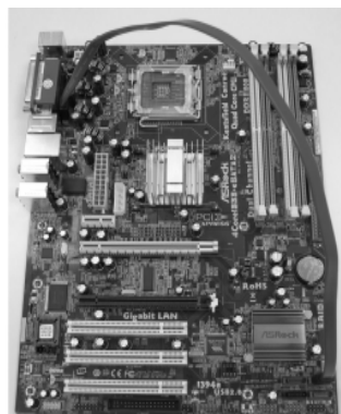
SATAデータケーブルをオレンジeSATAIIコネクタ(eSATAII)に接続します
