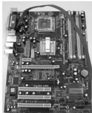
Connectez le câble de données SATA au connecteur SATAII (eSATAII)
