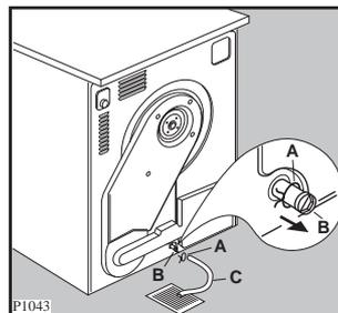
Cette solution peut être adoptée aussi lorsque le sèche-linge est installé en colonne sur le lave-linge. Faites attention à ce que le tuyau soit orienté vers le bas (voir croquis ci-dessous).
