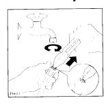
Si l'on remarque que la machine prend plus de temps à se remplir, il est conseillé de contrôler que le filtre du tuyau d'arrivée d'eau ne soit pas bouché. Fermer le robinet de l'eau. Dévisser l'embout du tuyau du robinet. Extraire le filtre de son logement, le nettoyer avec une petite
