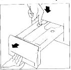
Les détergents et l'assouplissant s'incrustent à la longue. Nettoyer de temps en temps le tiroir bacs à produits sous un jet d'eau. A cette fin il est possible d'extraire complètement le tiroir de la machine en appuyant sur l'arrêt au fond à qauche.
