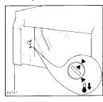
L'appareil a été réglé à l'usine pour consommer peu d'eau (la phase de refroidissement n'a pas été prévue automatiquement).
