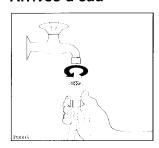
Brancher le tuyau d'arrivée à un robinet fileté au pas de gaz de ¾" après avoir interposé le petit filtre livré avec l'appareil.
