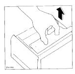
Pour faciliter le nettoyage la partie supérieure du bac réservé à l'assouplissant peut être enlevée.
