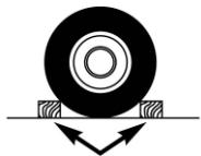
6. Calez l'avant et l'arrière de la roue diagonalement opposée à l'emplacement du cric. Exemple : pour changer la roue
