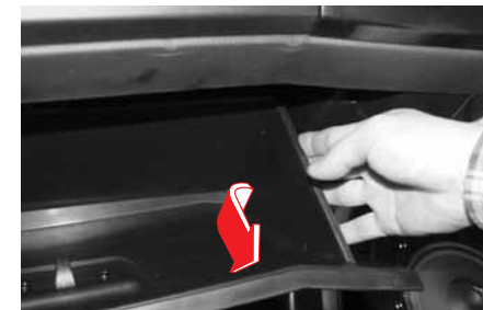
3. Enfoncez le côté droit de la boîte à gants dans le sens de la flèche.
