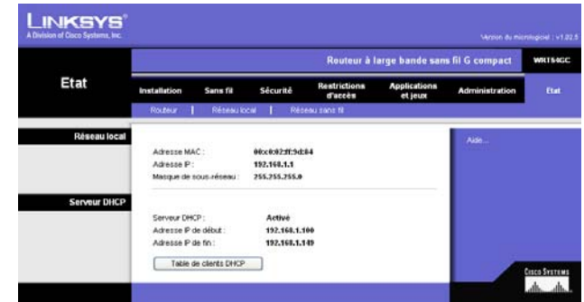
Figure 5-38 : Onglet Etat - Routeur
