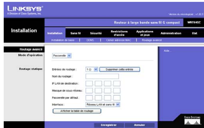
Figure 5-13 : Onglet Installation - Routage avancé (Routeur)
