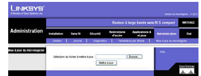
Figure 5-37 : Onglet Administration - Mise à jour du micrologiciel
