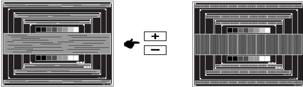
**NOTE** ■ En cas d'un fort scintillement ou d'un manque de netteté sur une partie de l'écran, répétez les étapes ⑥ et ⑦, car l'ajustement de l'Horloge peut ne pas avoir été effectué correctement. Si le scintillement ou le manque de netteté persiste, paramétrez le taux de rafraîchissement de l'ordinateur sur une fréquence basse (60Hz) et reprenez les réglages à partir de l'étape ③.
