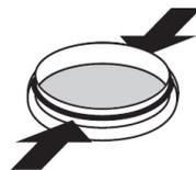
**Remarque:** Veillez à ce que le joint d'étanchéité soit bien positionné et pas endommagé.
