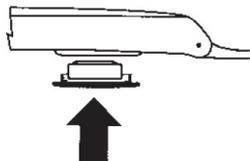
Pressez le couvercle de la batterie depuis le bas dans le boîtier de la montre, avec la batterie en place.
