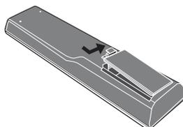
**Étape 2** Insérer deux piles de type AAA. Faire coïncider les pôles (+) et (-) des piles et les extrémités (+) et (-) indiquées dans le logement pour piles. Replacer le couvercle en place.
