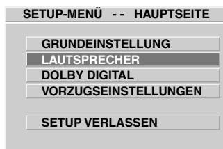
Durch Drücken der Taste »ENTER« 21 das Menü LAUTSPRECHER aufrufen. Bei **AUDIO MODE** muss **5.1 CH** eingestellt sein.
