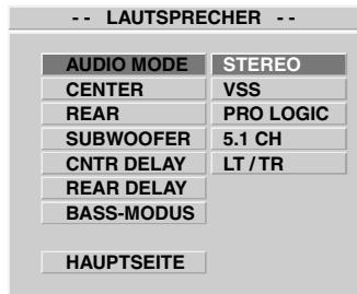
A 21 jelű »▲/▼« gombokkal válassza az 5.1 CH-t, és erősítse meg a 21 jelű »**ENTER**« gombbal! A képernyőről való eltüntetéshez nyomja meg a 20 jelű »**SETUP**« gombot!
