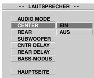
Die Taste »►« drücken und mit den Tasten »▲/▼« **EIN** oder **AUS** hervorhaben. Mit der Taste »ENTER« 21 die Auswahl bestätigen.
