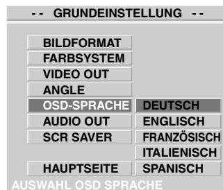
Die Taste »\_« 21 drücken und mit den Tasten »5/6« 21 die gewünschte Sprache hervorheben. Mit der Taste »ENTER« 21 die Einstellung bestätigen.
