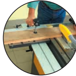
Fonction tronçonnage au chariot Cutting into length with carriage
