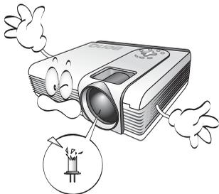
3. Ne remplacez jamais la lampe ni aucun composant électronique tant que le projecteur n'est pas débranché.
