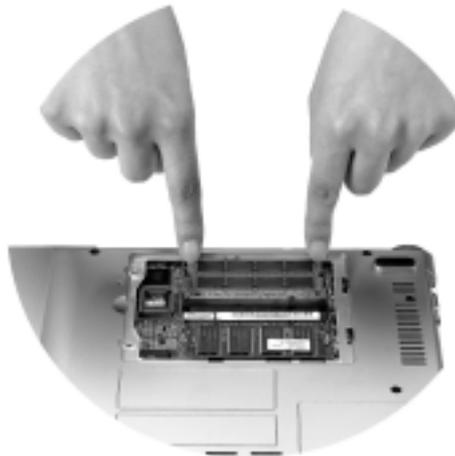
**4.** Appuyez sur le bord supérieur du module de mémoire jusqu'à ce qu'il soit entièrement inséré.
