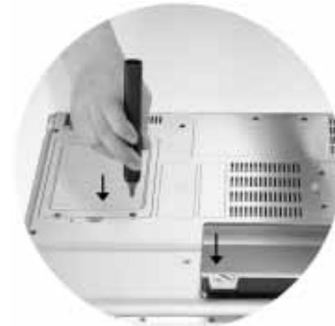
**5.** Revissez le volet. Insérez la batterie, puis rebranchez l'adaptateur secteur. Au démarrage de l'ordinateur, le nouveau module mémoire est testé et configuré automatiquement.
