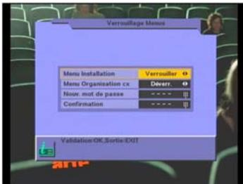
Une fois le mot de passe entré, il est possible de Verrouiller/Déverrouiller les accès aux menus «Installation», et «Organisation des Canaux» par mot de passe. Vous pouvez aussi changer le mot de passe. Dans ce cas, ne l'oubliez pas.
