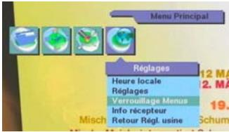
Pour éviter les fausses manœuvres, le sous-menu «Verrouillage des menus» est verrouillé en réglage usine. Il permet d'autoriser ou bloquer l'accès aux menus «Installation» et «Organisation Ch.» ainsi que de changer le mot de passe.
