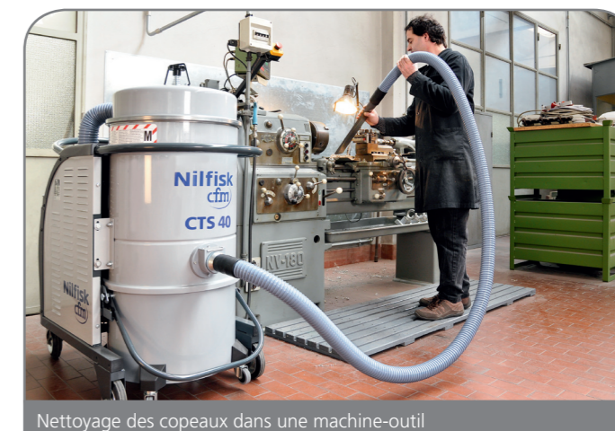
Nettoyage des copeaux dans une machine-outil
