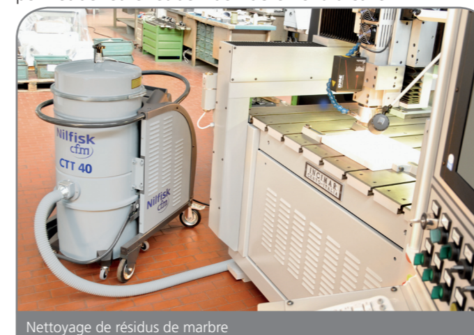
Nettoyage de résidus de marbre
