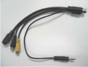
Câble entrée de ligne pour carte de capture TV haut de gamme
