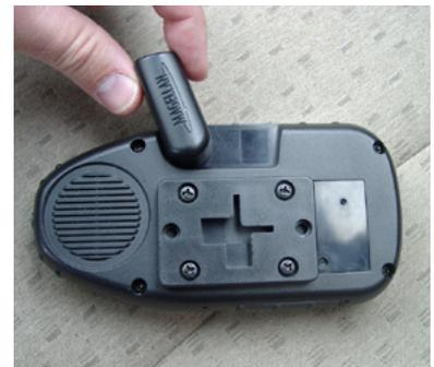
Tenez l'antenne par le bas et détachez-la du dos de l'appareil.
