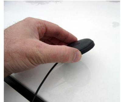
Faites cheminer le câble de l'antenne de manière à ce qu'il n'interfère pas avec le fonctionnement du véhicule.
