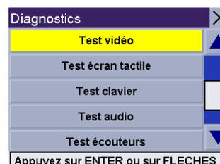
**Test écran tactile** vérifie que l'écran tactile est calibré et précis.
