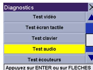
**Test écouteurs** vérifie que le son est transmis correctement à la prise jack des écouteurs.
