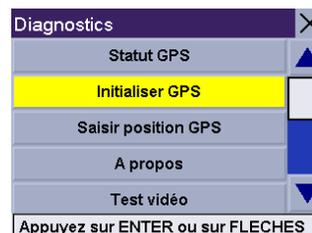
**Saisir position GPS** vous permet de saisir manuellement les coordonnées de l'icône de position actuelle. Si vous avez parcouru une longue distance avec l'appareil désactivé, la réacquisition du signal satellite peut prendre un certain temps. En réglant manuellement cette fonction de l'appareil, vous indiquez votre position actuelle et accélérez ainsi l'acquisition du signal satellite. Deux options s'offrent à vous pour régler votre position GPS :
