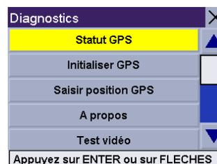
**Initialiser GPS** réinitialise l'appareil et acquiert à nouveau le signal satellite.
