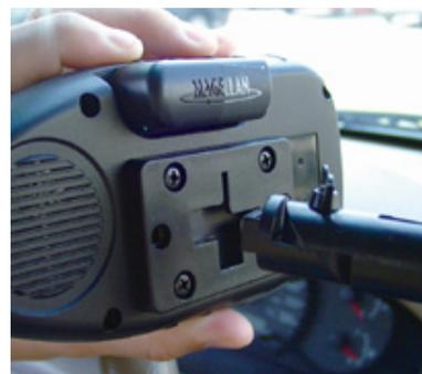
Pressez la ventouse contre le pare-brise et faites tourner la molette de verrouillage jusqu'à entendre un déclic.
