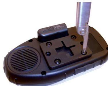
Faites glisser l'ensemble de fixation sur le support de fixation sur pare-brise que vous venez de fixer au dos du récepteur.
