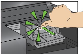
d) Poussez **fermement** sur l'étiquette cible de la tête d'impression jusqu'à ce que celle-ci **s'enclenche**.
