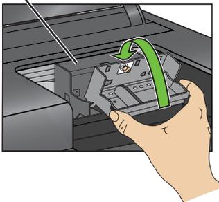
c) Insérez la tête d'impression dans le chariot en l'inclinant comme dans l'illustration.
