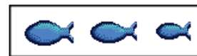
Symboles de poisson de couleur bleue captés par le faisceau large de 83 kHz
