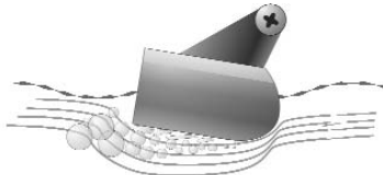
Cavitation causant des lectures irrégulières au sonar
