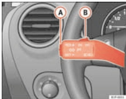
Fig. 123 Levier des clignotants et de l'inverseur-codes : commandes du régulateur de vitesse
