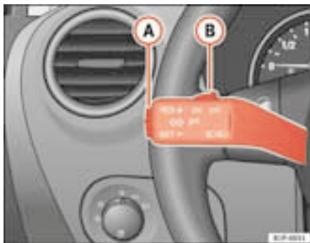
Fig. 125 Levier des clignotants et de l'inverseur-codes : commandes du régulateur de vitesse
