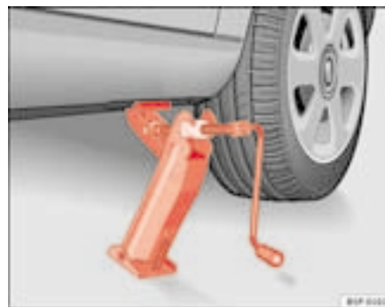
Fig. 154 Mise en place du cric
