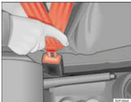
Fig. 11 Boîtier de verrouillage et pêne de la ceinture de sécurité
