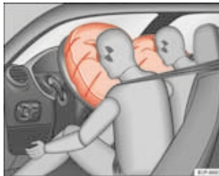
Fig. 19 Schéma de principe : airbags frontaux gonflés
