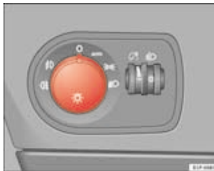
Fig. 73 Allumage automatique des feux
