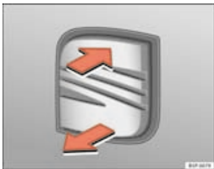
Fig. 65 Capot de coffre : ouverture de l'extérieur
