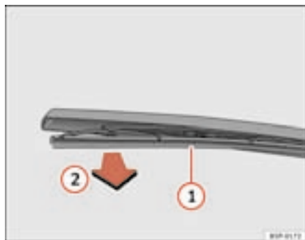
Fig. 146 Remplacement du balai d'essuie-glace arrière
