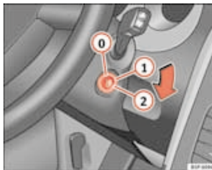
Fig. 113 Positions de la clé de contact
