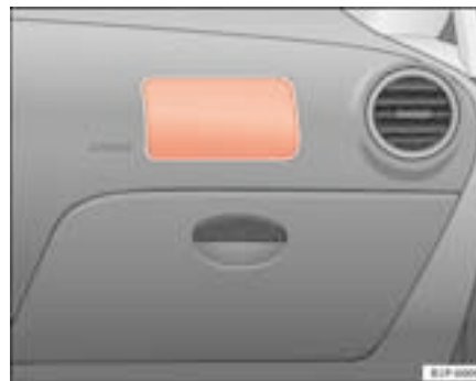
Fig. 18 Emplacement de montage de l'airbag du passager avant : dans le tableau de bord
