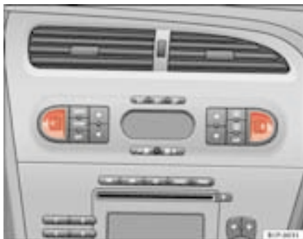
Fig. 91 Molettes des chauffages de sièges avant
