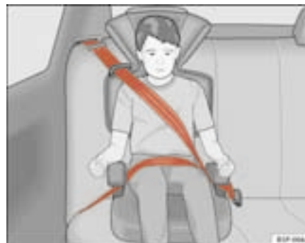
Fig. 29 Siège pour enfants monté dans le sens de la marche sur la banquette arrière.
