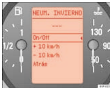
Fig. 45 Afficheur numérique du combiné d'instruments : indicateur des pneus d'hivers
