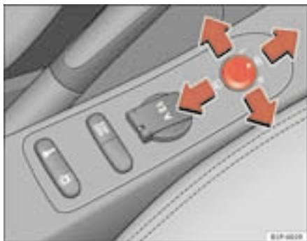
Fig. 86 Commande des rétroviseurs extérieurs
