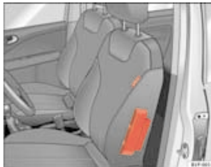
Fig. 21 Airbag latéral dans le siège du conducteur
