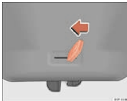
Fig. 67 Hayon arrière : ouverture d'urgence
