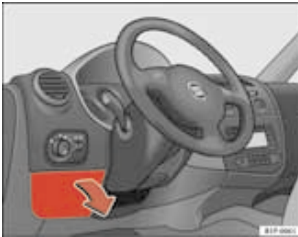
Fig. 157 A gauche dans le tableau de bord : cache de la boîte à fusibles
