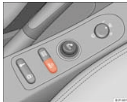
Fig. 47 Console centrale : touche du système de contrôle des pneus
