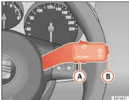
Fig. 40 Levier d'essuie-glace/de lave-glace : touche A et commande à bascule B
