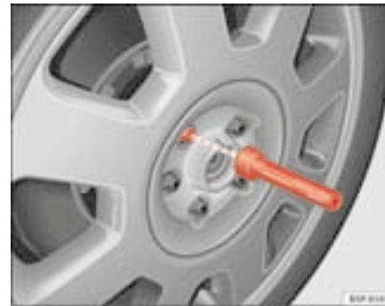
Fig. 155 Changement de roue : Outil à six pans creux pour tourner les boulons
