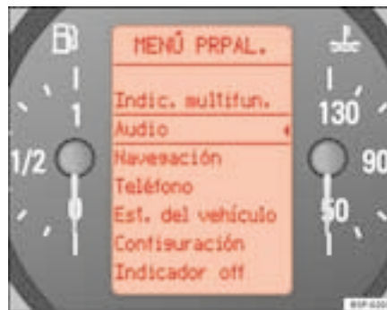
Fig. 43 Afficheur numérique du combiné d'instruments : Menu principal
