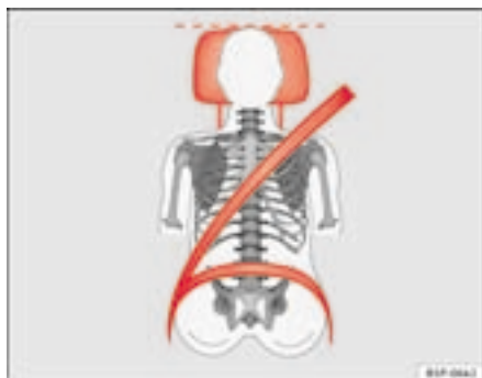
Fig. 87 Vue de face : appuie-tête convenablement réglé et ceinture correctement ajustée
