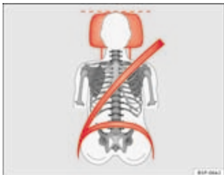
Fig. 3 Appuie-tête correctement réglé, vu de l'avant
