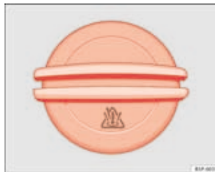
Fig. 143 Dans le compartiment-moteur : bouchon du vase d'expansion du liquide de refroidissement
