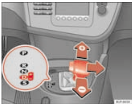
Fig. 120 Changement de vitesses avec la commande tiptronic
