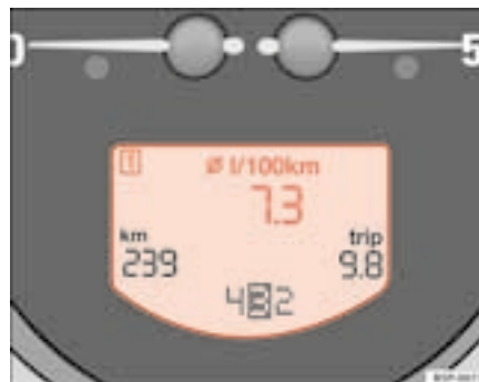
Fig. 39 Afficheur numérique du combiné d'instruments : indicateur consommation moyen de carburant
