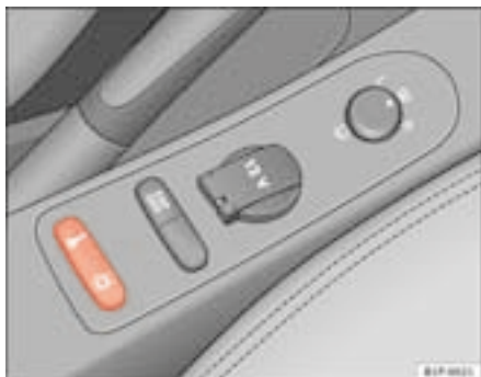
Fig. 59 Détail de la console centrale : touche de verrouillage centralisé
