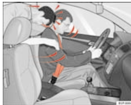
Fig. 9 Le passager arrière non sanglé est projeté en avant et vient heurter le conducteur sanglé.
