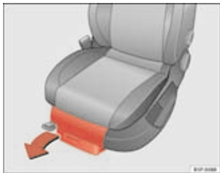
Fig. 95 Rangements sous les sièges avant
