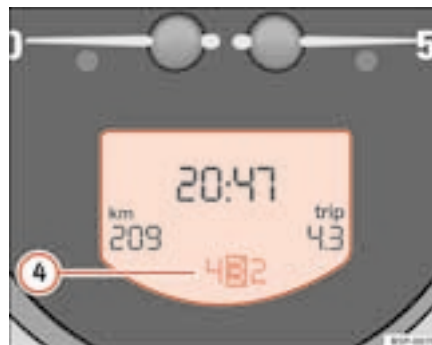
Fig. 36 Détail du combiné d'instruments : afficheur avec indication du rapport en mode tiptronic
