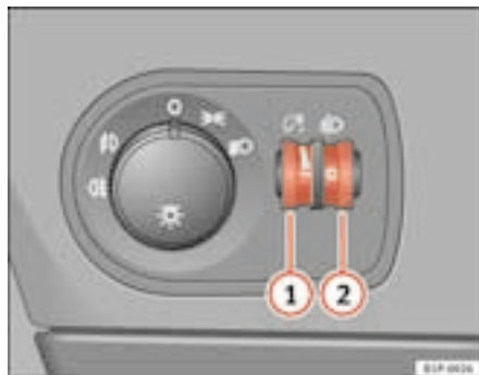
Fig. 74 Détail du tableau de bord : molettes du rhéostat d'éclairage des cadrans et des commandes et du réglage du site des projecteurs
