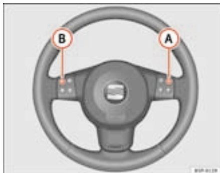
Fig. 56 Commandes au volant version Audio + Téléphone
