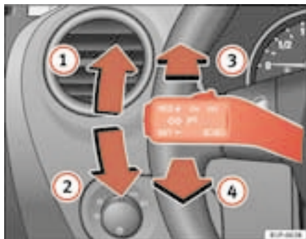
Fig. 76 Levier des clignotants et de l'inverseur-codes
