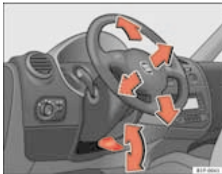
Fig. 110 Réglage de la position du volant de direction
