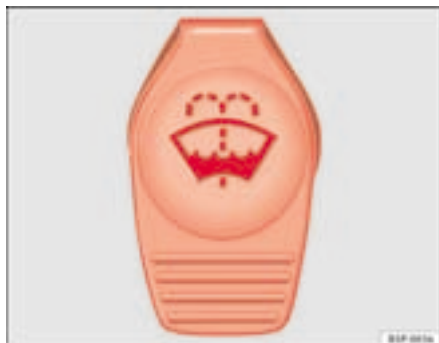
Fig. 144 Dans le compartiment-moteur : bouchon du réservoir de lave-glace
