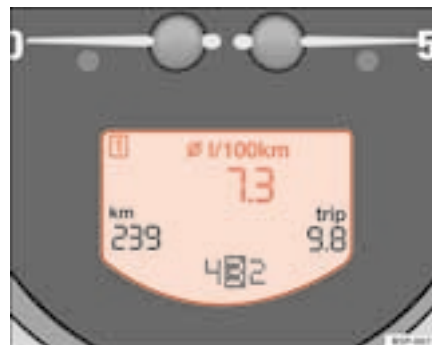
Fig. 41 Afficheur numérique du combiné d'instruments : indicateur consommation moyen de carburant.
