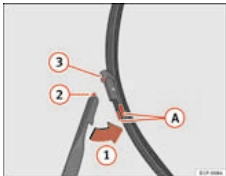
Fig. 145 Remplacement des balais d'essuie-glace avant
