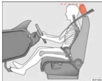
Fig. 2 Réglage correct de l'appuie-tête du conducteur
