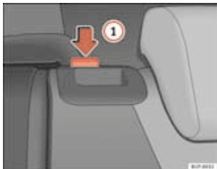
Fig. 93 Lever le dossier du siège arrière
