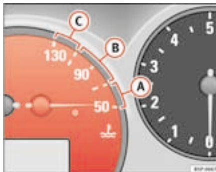
Fig. 34 Détail du combiné d'instruments : indicateur de température de liquide de refroidissement
