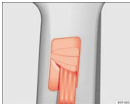
Fig. 16 Emplacement de montage du dispositif de réglage en hauteur des ceintures
