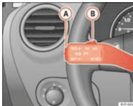
Fig. 124 Levier des clignotants et de l'inverseur-codes : commandes du régulateur de vitesse
