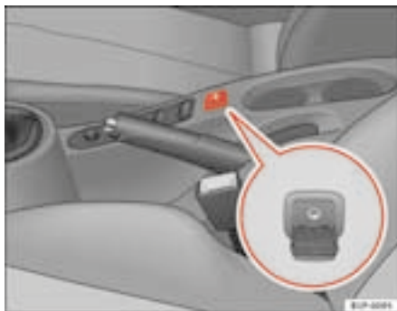
Fig. 101 Connecteur pour l'entrée auxiliaire audio
