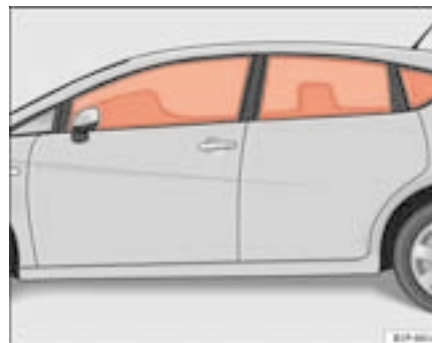
Fig. 24 Schéma de principe : airbags de tête gonflés
