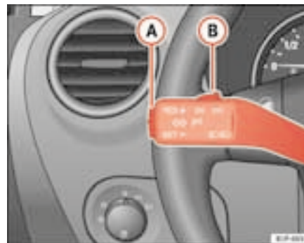
Fig. 122 Levier des clignotants et de l'inverseur-codes : commandes du régulateur de vitesse
