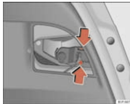
Fig. 169 Démontage du porte-lampes
