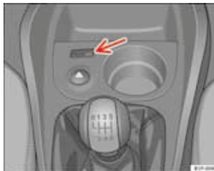
Fig. 26 Témoin de désactivation de l'airbag du passager
