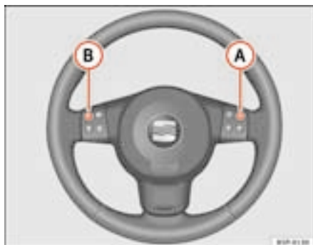
Fig. 57 Commandes au volant version Audio
