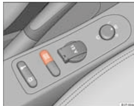
Fig. 112 Détail de la console centrale : touche ESP
