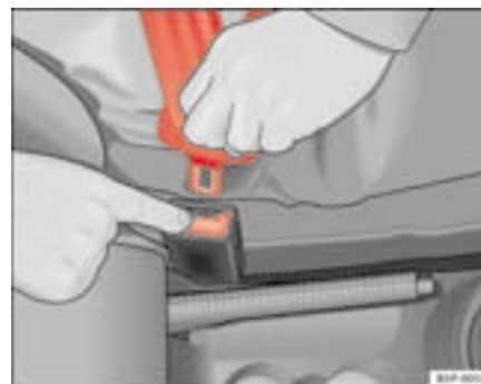
Fig. 15 Libération du pêne du boîtier de verrouillage
