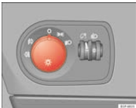
Fig. 72 Détail du tableau de bord : commandes d'éclairage, des projecteurs antibrouillard et du feu arrière de brouillard
