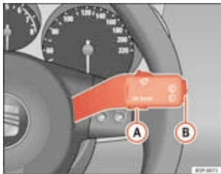
Fig. 38 Levier d'essuie-glace/de lave-glace : touche A et commande à bascule B
