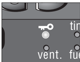
I: Zapalenie się lampki kontrolnej KEY-LOCK oznacza uruchomienie mechanizmu zamka zabezpieczającego.
