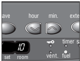
K: Wenn die Kontroll-Lampe FUEL aufleuchtet, wird im Informations-Display angezeigt, für wieviele Minuten Sie noch Brennstoff haben.
