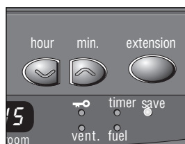
J: Si la lampe témoin SAVE s'allume, l'appareil s'allume et s'éteint automatiquement afin de rester dans les limites d'une certaine plage de températures.
