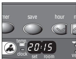
G: Den ønskede temperatur angives til venstre og den aktuelle til højre.
