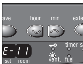
L: Als het controlelampje VENT knippert, is dat een teken dat u extra moet ventileren.
