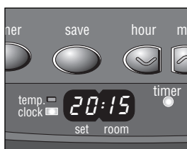
G: La lampe témoin TIMER indique que la fonction timer est active.
