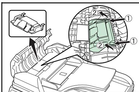
1 Appuyer sur les crochets (x2) indiqués sur la figure, soulever et retirer le séparateur.
