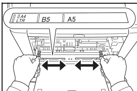
**3** Régler la position des guides de papier du bac MF. Les formats de papier standard sont indiqués sur le bac MF. Pour les formats de papier standard, faire coulisser les guides de papier jusqu'à la position correspondante.
