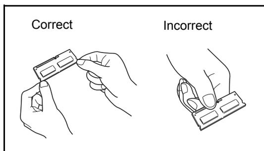
Pour protéger les parties électroniques, décharger l'électricité statique de votre corps en touchant une canalisation d'eau (robinet) ou tout autre grand objet métallique avant de manipuler le module de mémoire. Si possible, porter un bracelet antistatique lors de l'installation du module de mémoire.
