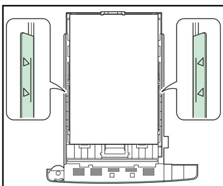
**REMARQUE :** Ne pas charger plus de papier que les limites de charge des guides de papier. Le magasin contient jusqu'à 500 feuilles de papier normal A4 ou inférieur (80 g/m<sup>2</sup>).
