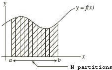
Le calcul d'intégrale est réalisé à l'aide de la loi de Simpson pour déterminer la fonction  $f(x)$ . Pour cela il est nécessaire de partitionner la surface servant au calcul d'intégration. Si vous ne spécifiez pas de valeur  $n$ , la calculatrice décidera elle-même de la valeur  $N$  à utiliser.
