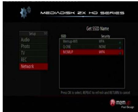
**Remarque :** Dans la liste de Sécurité, **WEP** (Wired Equivalent Privacy) et **WPA** (Wi-Fi Protected Access) indiquent que le réseau est codé, c'est-à-dire qu'une clé de cryptage est nécessaire pour accéder au réseau. **NONE** (aucun) indique qu'il s'agit d'un réseau ouvert.
