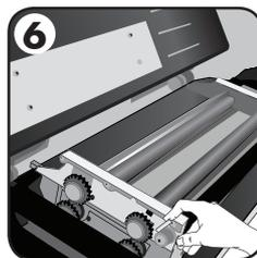
6. Pour l'entretien poursuivi, les rouleaux peuvent être retirés par les utilisateurs expérimentés. Appuyer sur les leviers de la came pour libérer les rouleaux.
