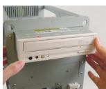
Installazione di un'unità ottica
