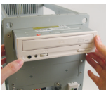
Instalação de uma unidade óptica
