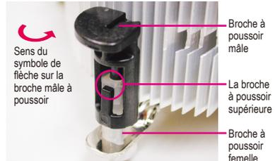
Etape 2 : Avant d'installer le dispositif de refroidissement, notez le sens du symbole de la flèche sur la broche à pousser mâle. (en faisant tourner la broche à pousser dans le sens de la flèche pour retirer le dispositif de refroidissement, dans le sens contraire pour l'installer.)
