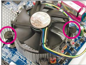
Etape 3 : Placez le dispositif de refroidissement au sommet de l'unité centrale, en alignant les quatre broches à pousser à travers les orifices de broche sur la carte mère. Appuyez vers le bas pour pousser les broches à pousser diagonalement.
