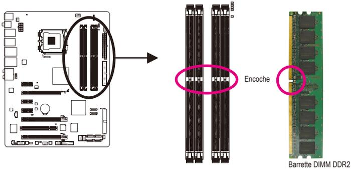
Un module de mémoire DDR2 possède une encoche pour être inséré dans un sens uniquement. Suivez les étapes ci-dessous pour installer correctement vos modules de mémoire dans les supports de la mémoire.
