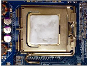
Etape 1 : Appliquez une couche fine homogène de graisse thermique sur la surface de l'unité centrale installée.
