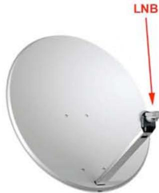
Le LNB (Low Noise Block convert, convertisseur de bloc de faible bruit), qui a été introduit pour pallier à ce problème est utilisé pour manipuler une large bande de fréquences relativement élevées, les amplifier et les convertir en signaux similaires transportés à une fréquence bien plus basse qui est appelée fréquence intermédiaire (IF).
